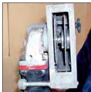
Rainureuse à disques diamants réglable en largeur et en profondeur.
